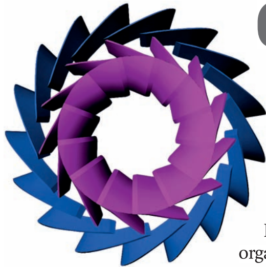
Abb. 2: CFD-opti- mierter Leit- und Laufschaukelkranz
